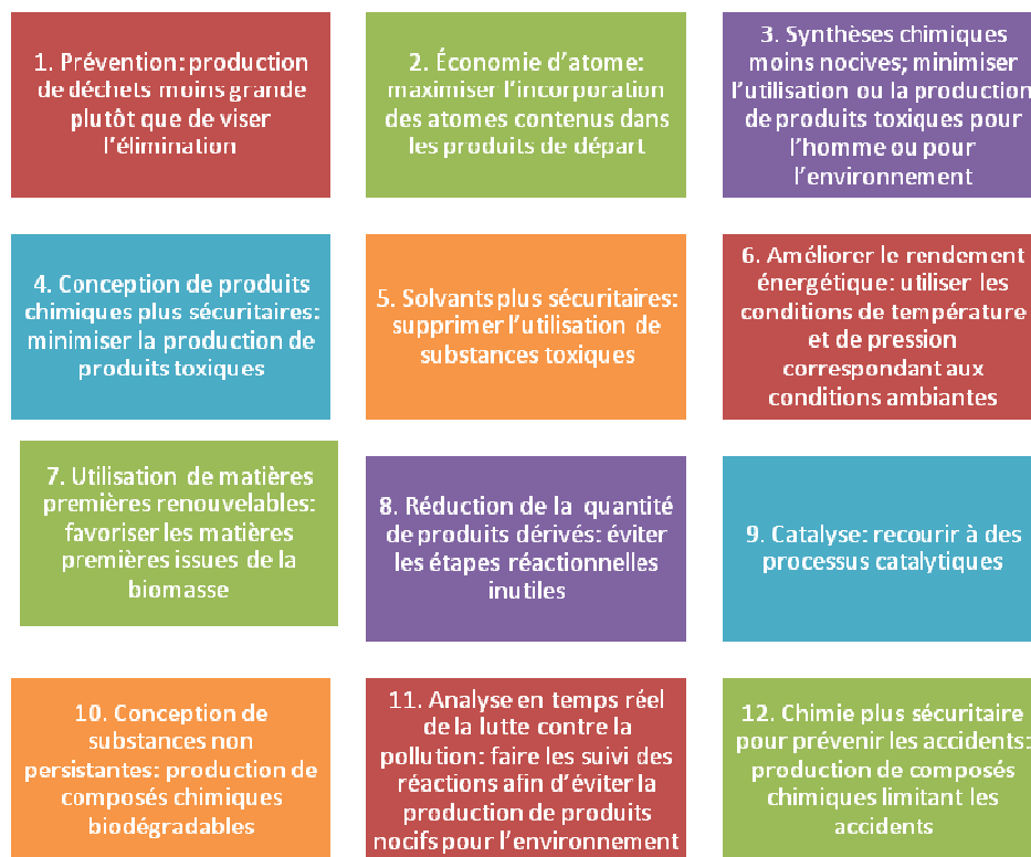
Figure 2. 3 Les principes de la chimie verte (Adaptation de Jamart, Bodiguel et Brosse, 2009, p. 594-595)
