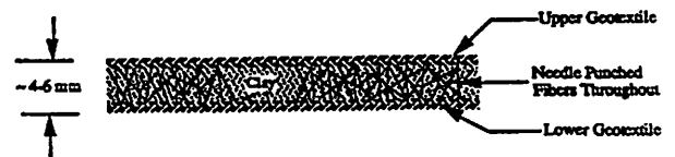
Figure 2 : GCB obtenu par aiguilletage avec la bentonite entre les géotextiles
