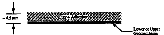
Figure 5 : GCB obtenu par adhésion chimique de la bentonite sur une géomembrane
