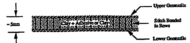
Figure 3 : GCB obtenu par couture avec la bentonite entre les géotextiles
