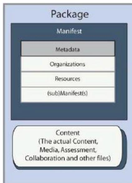
Figure 1 Structure d'un package XML SCORM
