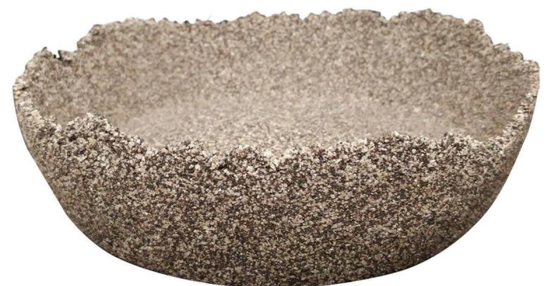
Les propriétés de l'échantillon 57, constitué de chaux, de marc de café et de colle de gélatine (GGV), semble satisfaire nos objectifs jusqu'à présent pour ce qui est de la solidité/dureté et de la biodégradabilité, du temps de séchage et de la mise en forme.
